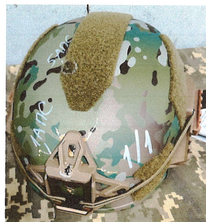
Фото зразка 1/1 після випробувань
